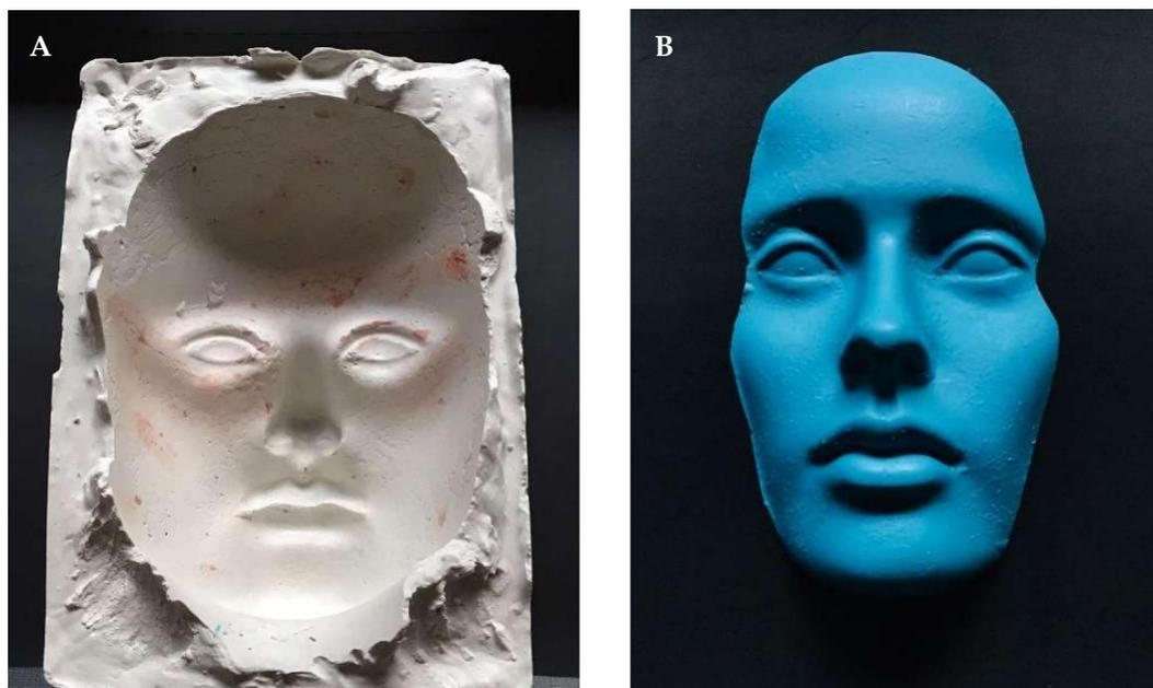
**Figura 1:** A. Molde de gesso comum. B. Modelo de borracha de silicone.
